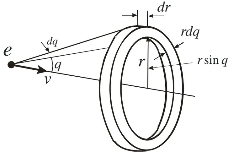
Fig. 1. The element the volume  $2\pi r^2 \sin q dq dr$ , utilized for the calculation energy pour on that moving the electron.
